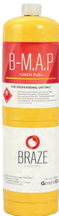
B-M.A.P. è una miscela di gas speciale con alto potere calorico ed è adatta a lavori di saldatura e saldobrasatura. La temperatura della fiamma può arrivare fino ai 3.100°C ed è più veloce del 35% rispetto al gas propano. La bombola B-M.A.P. è in acciaio (costruita in accordo alla Norma EN 12205); la sua capacità è pari a 1 litro e contiene 420 grammi di prodotto - Valvola USA CGA 600.
