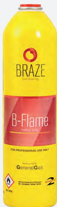
B-FLAME è una miscela di gas con aggiunta di chemtane, che aumenta il calore della fiamma. La temperatura della fiamma può arrivare fino ai 2.900°C. La bombola B-FLAME è prodotta in alluminio. Ha una capacità di 1 litro e contiene 385 gr. di prodotto - Valvola Aerosol - Attacco 7/16" 20 UNF (attacco più comunemente utilizzato in Europa). È disponibile in confezioni da 6 bombole.
