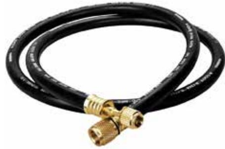
Tubazione Fieldpiece costruita specificamente per alto vuoto, quadruplo strato, tripla crimpatura sulle connessioni, colore nero, attacchi 1/4 x 3/8, lunghezza 150 cm.
