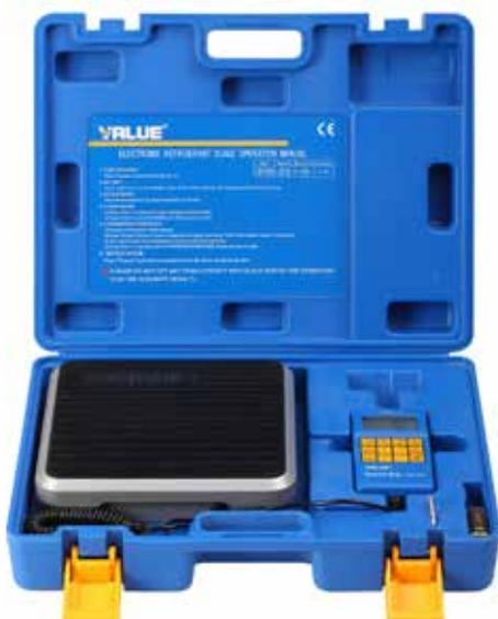
Bilancia per la ricarica di gas refrigeranti con comando remoto e display LCD.
