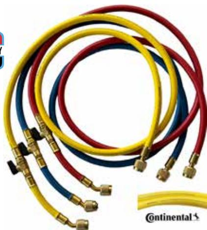
Tubazioni di carica linea PRO di elevata qualità, interamente Made in Italy, con valvola lato 45°, attacchi 1/4" su entrambi i lati, corredate di valvola a sfera intermedia e depressore. Lunghezza 150 cm.
