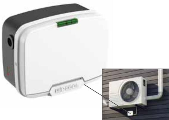
**Pompa di atomizzazione della condensa P15J - portata 10 litri/ora con 2 ugelli**, adatta per split fino a 30.000 BTU/ora (8,8 kW), serbatoio incorporato 35 ml.
