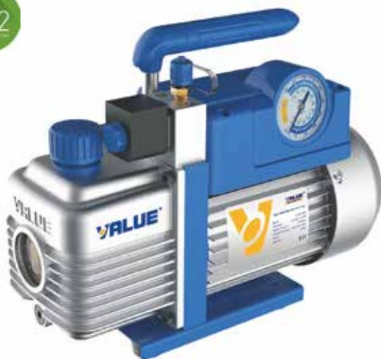
Pompa vuoto doppio stadio, adatta anche per R32 e A2L, portata 198 litri/minuto, motore 1 HP - grado di vuoto 2 x10(-2) mbar - 0,02 mbar/2 Pa/15 micron - con elettrovalvola e vacuometro
